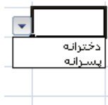
شکل ۶-۲۸ نتیجه استفاده از گزینه List در Data Validation
